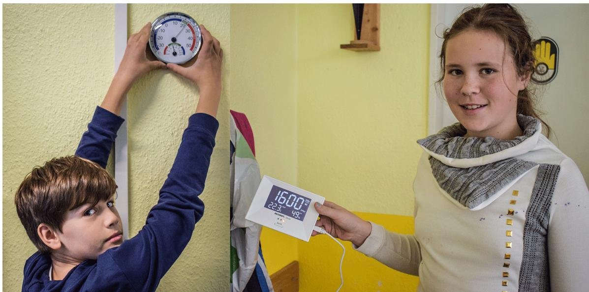
*Große, gut ablesbare Thermometer geben eine erste Orientierung über die Raumtemperaturen in allen Klassenräumen der Grundschule (Bild links). Messanzeigen für CO<sub>2</sub>, Temperatur und Luftfeuchte mit einer Ampelfunktion für den Kohlendioxidgehalt der Luft erleichtern das richtige Lüften im Winterhalbjahr (Bild rechts).*
